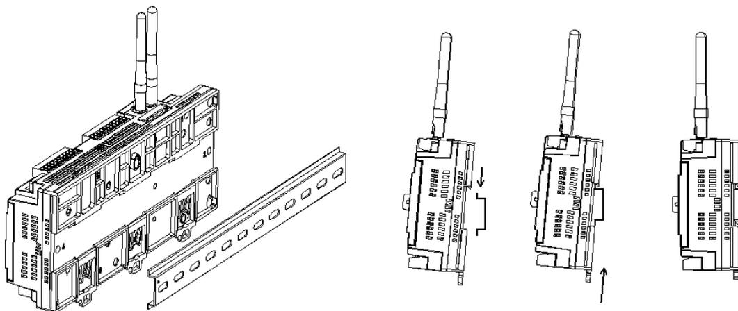
**Figure 3.7 DIN-Rail Installation**
