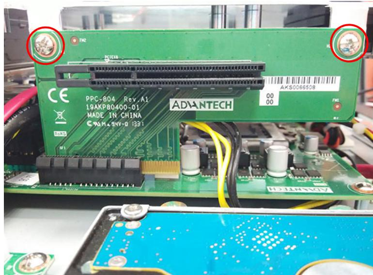
图 2.13：安装 PCIe 转接卡
