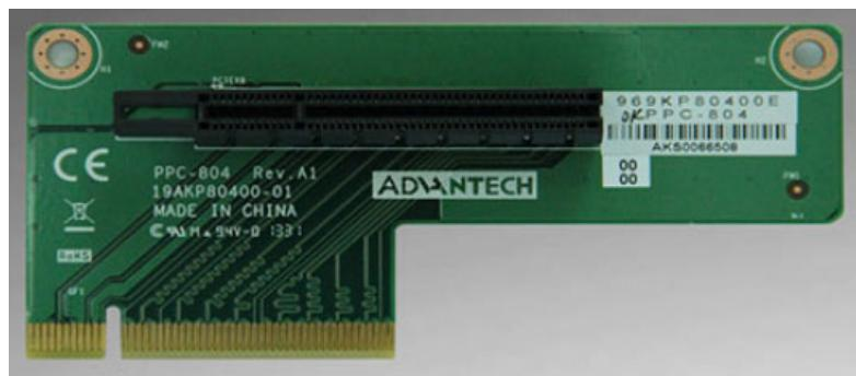
PPC-8150 /PPC-8170 PCIe 插槽可提供負載電流 (總共不大於 25 W)
