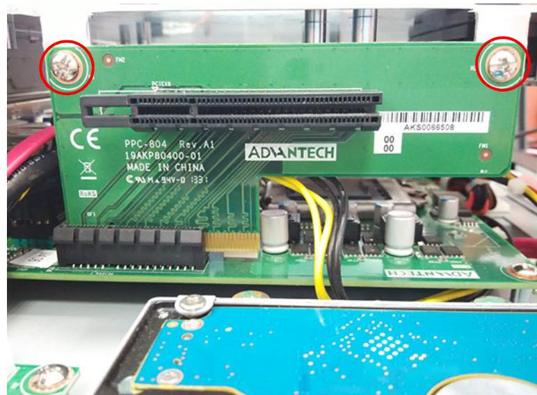
圖 2.13：安裝 PCIe 轉接卡
