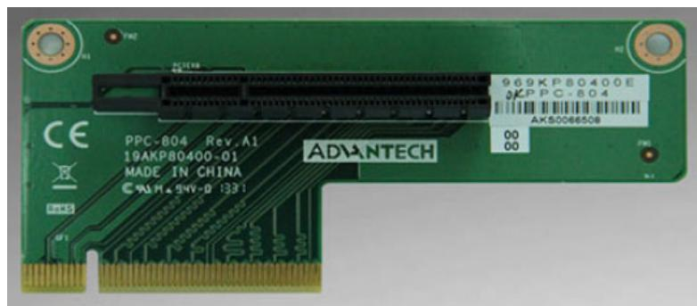
PPC-8150 /PPC-8170 PCIe 插槽可提供负载电流 (总共不大于 25 W)
