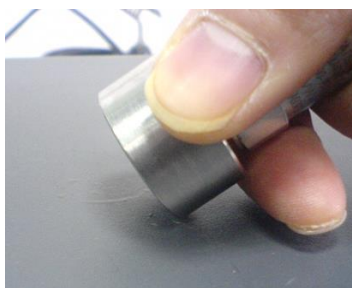
Рисунок 3. Установка магнитного основания.
